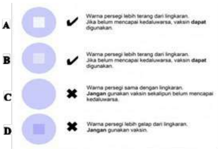
Gambar 6.13 Cara membaca indikator VVM
